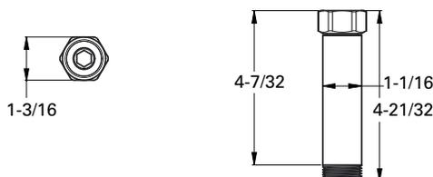
Trousse de soutien à élévation pour remplisseur de baignoire
